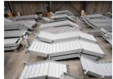
高層ビルや大型商業施設に設置される鉄骨階段。
