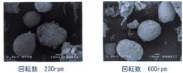
図6 攪拌回転数の違いによる酸化チタン(硫酸チタン)被覆 SEM 像
