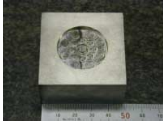
図2 モデル加工例(精密機械部品鑄造金型)
