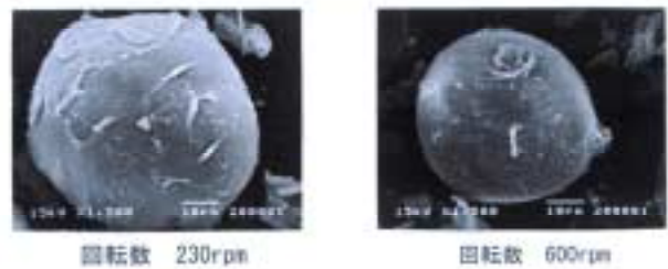
図7 攪拌回転数の違いによる酸化チタン(塩化チタン)被覆 SEM 像
