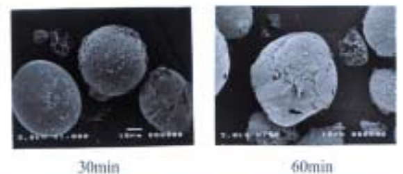
図13 攪拌時間の違いによる酸化チタン(塩化チタン)被覆 SEM 像
