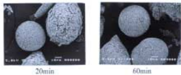
図12 攪拌時間の違いによる酸化チタン(硫酸チタン)被覆 SEM 像
