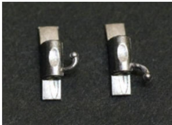
図21 折り曲げ試験前後の試作品
