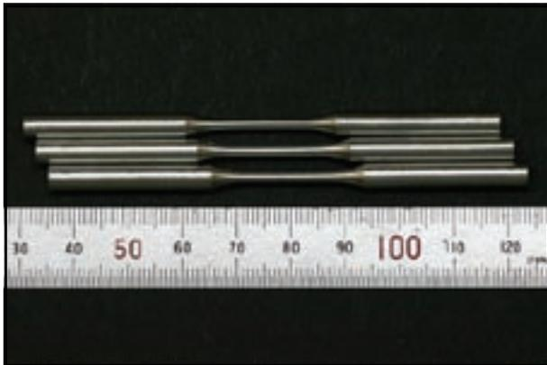
図2 MIMによる作製した引張試験片
