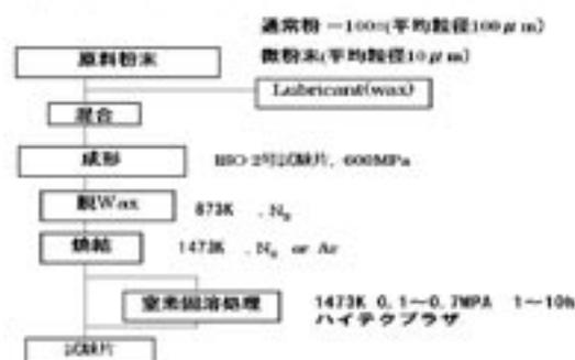
図 1 試験片の製造プロセス
