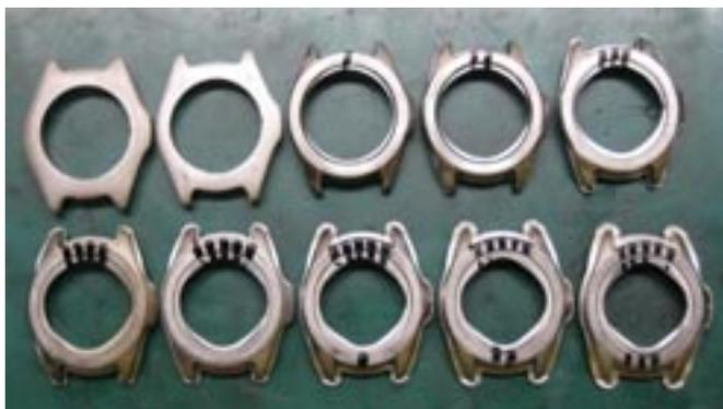
図 2 時計ケースの鍛造工程サンプル
