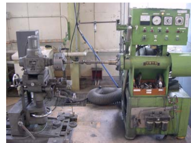
左：回転試験機 右：バフレース 図1 研磨試験機
