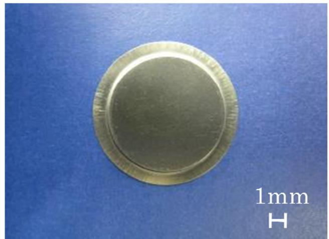
図14 圧力センサーのダイアフラム (板厚 0.1mm)
