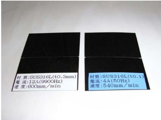
溶接突合せ継手試験片
