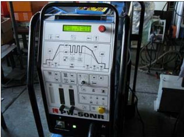
図 15 マイクロプラズマ溶接機
