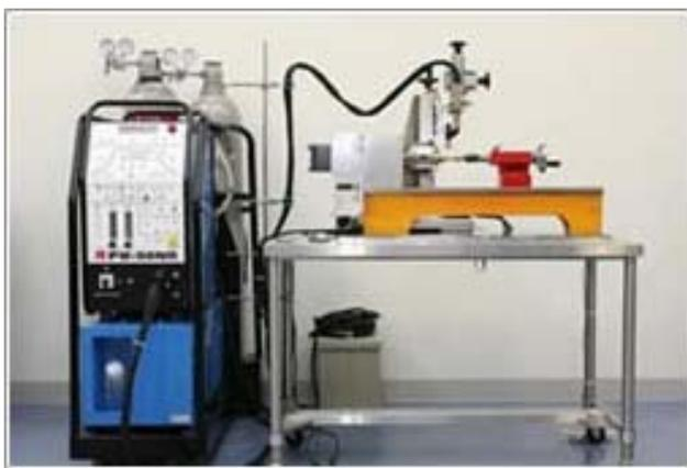
図 16 回転制御付溶接治具とのセットアップ例
