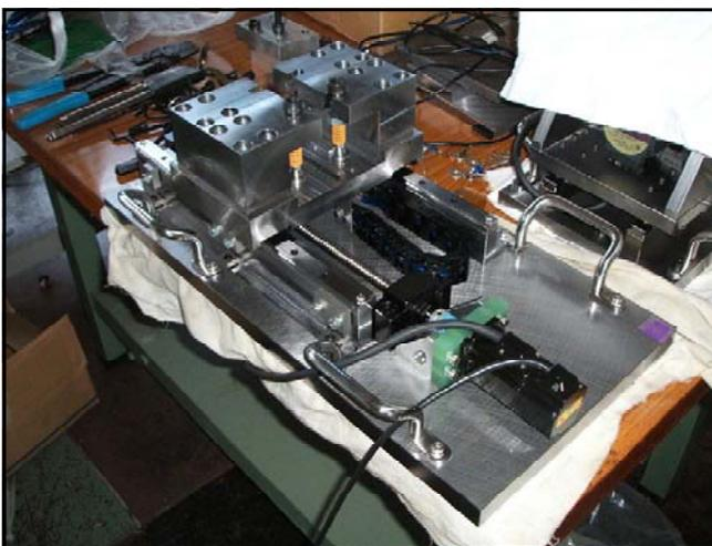
図7 溶接用治具(Ⅲ型)
