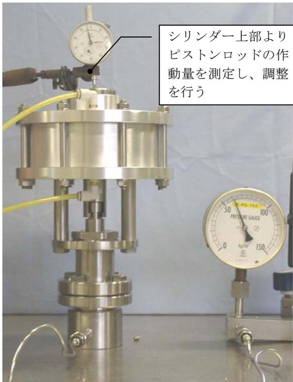
図 15 寿命試験（作動量調整）
