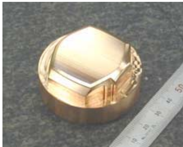
時計フレーム鑄造金型の放電加工用電極 材質：純銅 使用工具：5本（CrNコーティング超硬工具） 加工時間：4時間（磨き工程含む） 工程短縮率：約70%
