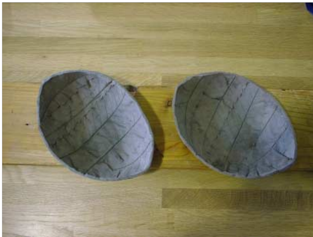
天然繊維と漆を使用した新しい塑性造形材料（木の葉の模様を転写した）
