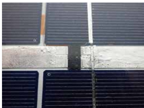
図4 内蔵した薄型バイパスダイオード
