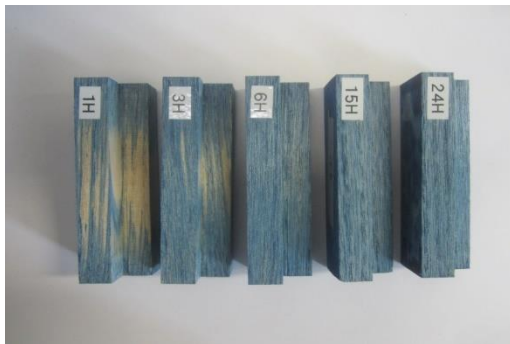
図4 加圧保持時間を変化させたときの試験片の様子 (H:時間)
