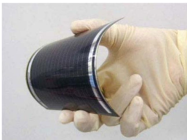
図 1 ステンレス箔基板を用いて作製したフレキシブル CIGS 太陽電池サブモジュール
